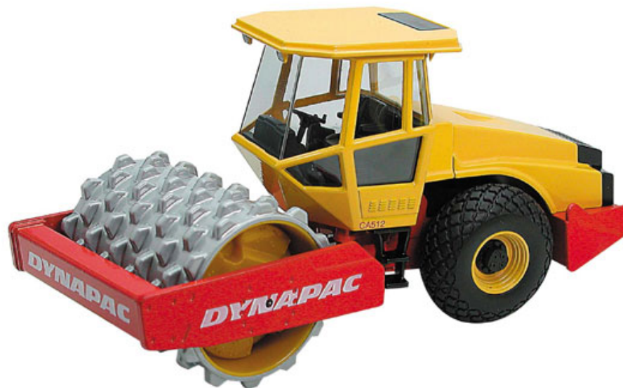
Fig. 5.1. Compactador tipo "pata de cabra".
