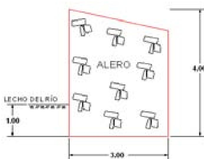
Se colocaran los aleros aguas arriba y aguas debajo de la alcantarilla, formando un ángulo de 35°, y con una longitud de 3.00 m. Dichos aleros serán construidos monolíticamente con los muros de contención, al inicio tendrán la misma altura que el muro pero ira disminuyendo a lo largo de su proyección con una pendiente del 33%.
