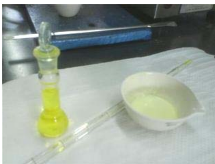
Figura 3.3. Impregnación del heteropoliácido.
