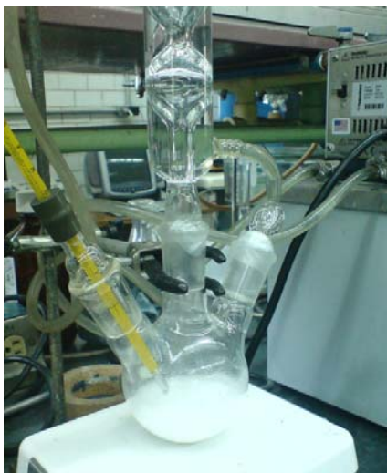
Figura 3.2. Reacción de impregnación del soporte.
