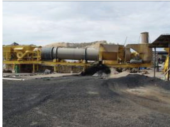
FOTO 8 Fotos nos. 8 y 9.- Planta de mezcla en caliente.
