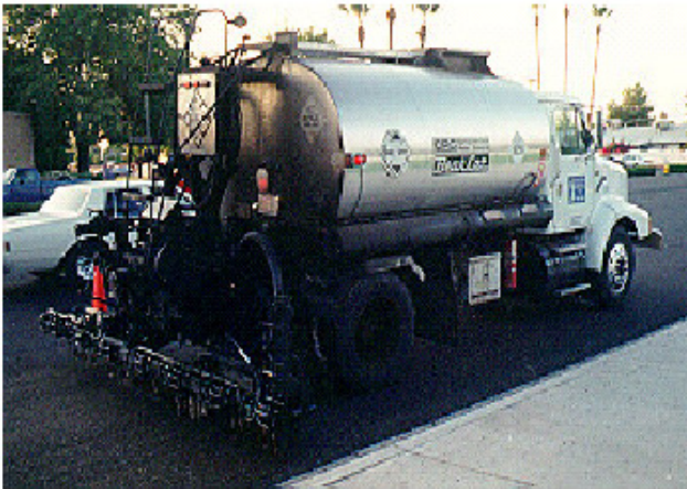
Foto 2 y 3.- Camiones con barra de distribución y con manguera de aplicación.
