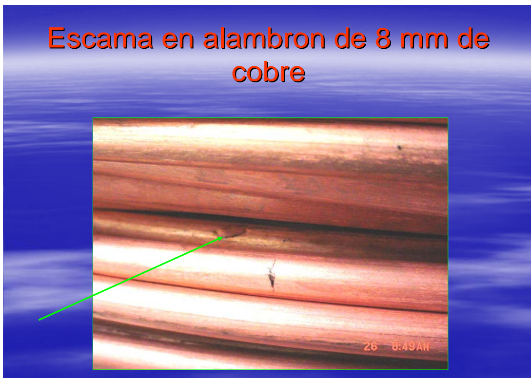
Foto. 2.1.a. Escamas en el alambρόn de cobre de 8 mm.
