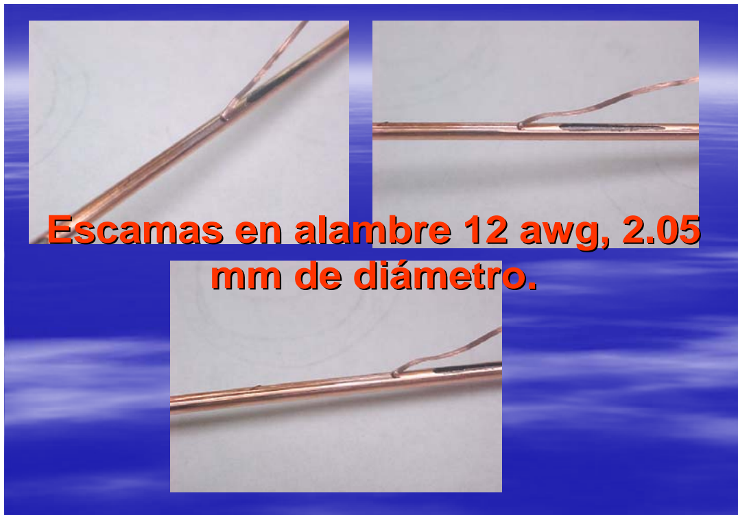
Foto 2.2. Defectos en el alambre de cobre.
