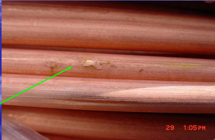
Foto 2.1.b. Escamas generadas en el alambreon de cobre.
