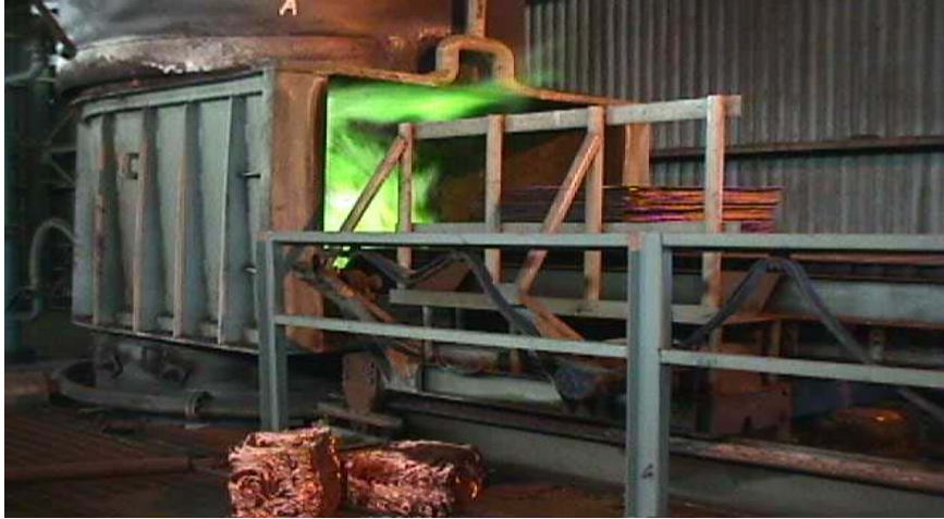
Foto 1.3. Carga a horno Asarco.
