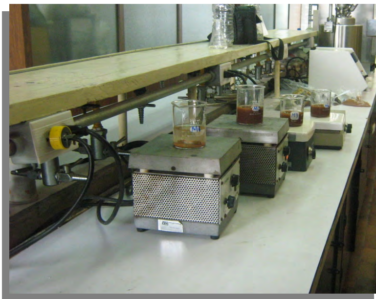
Fotografía 2. Un experimento de lixiviación con NaOH del mineral de Pb-Zn.
