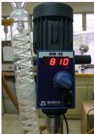
**Figura 5.** Motor de agitación con regulador de velocidad a 810 rpm.
