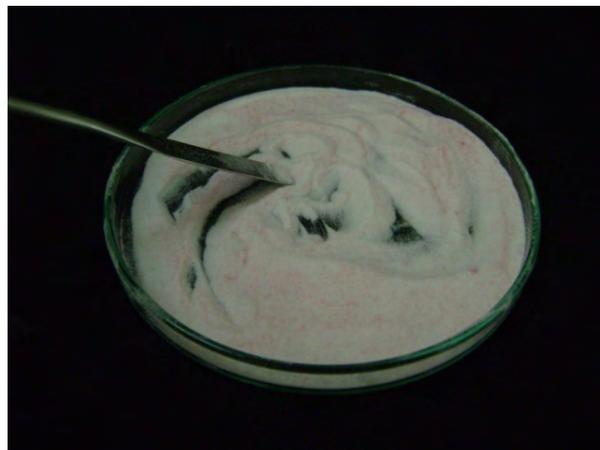
**Figura 14.** PMMA Experimental con 1 % de fibras flock.
