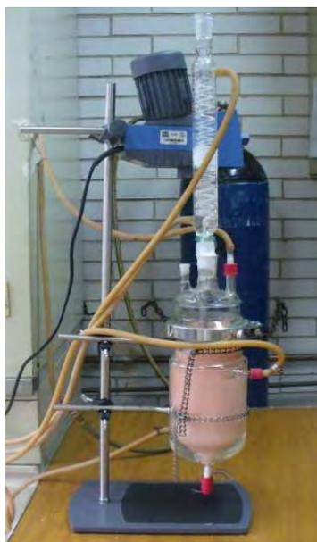
**Figura 6.** Síntesis de PMMA por suspensión en reactor de 5 entradas.
