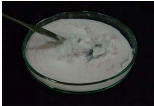
**Figura 12.** PMMA Experimental con 1 % de fibras de vidrio.
