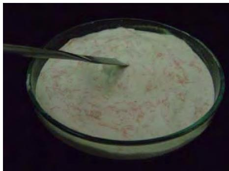
**Figura 13.** PMMA Experimental con 1 % de fibras de polietileno.
