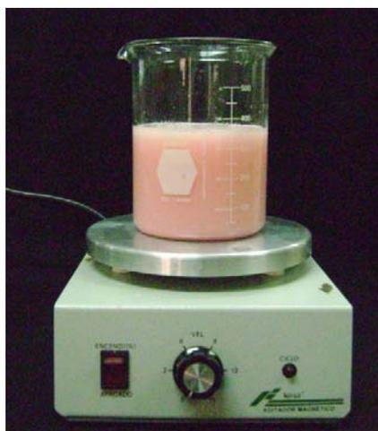
**Figura 4.** Mezcla de pigmentos en termoagitador.
