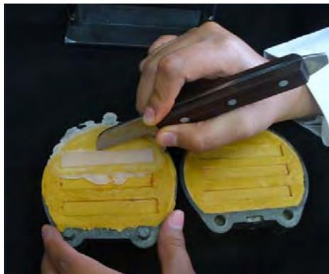
**Figura 19.** a) Material para enmuflado de muestras. b) Empacado de la resina acrílica en la mufla. c) Recortado de excedentes.
