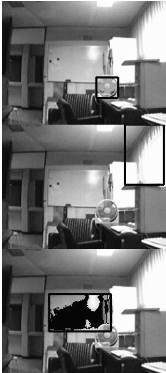
Figura 3.2: Localización dinámica: En este ejemplo tres regiones han sido detectadas utilizando el enfoque dinámico; en la primer imagen, de la superior a la inferior, se muestra una pequeña región que coincide estar sobre un objeto; en la segunda imagen siguiendo el mismo orden, es localizado una región la cual no coincide con ningun objeto, pero es detectado por la variacion de intensidades que se encuentran sobre la proyección captada por la cámara de la región correspondiente; en la tercer imagen, otra región coincide con un objeto.
