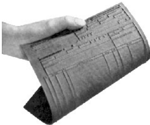
Imagen 119. Grabado en una mantilla de caucho.
