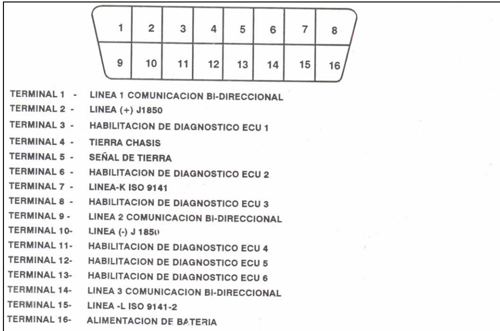
Figura 2.8 Terminales de conector DLC para transmisión de datos
