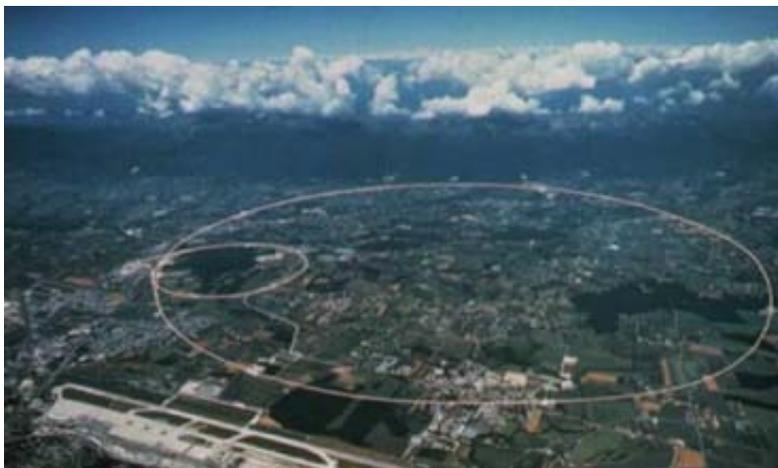
Figura 2.5 El gran círculo indica por donde pasa el gran acelerador electrón-positrón (LEP) del CERN (Laboratorio Europeo de Física de Partículas). El túnel donde se aceleran las partículas está a 100 metros bajo tierra y tiene 27 kilómetros de circunferencia. El círculo más pequeño indica la posición del acelerador menor de protones-
