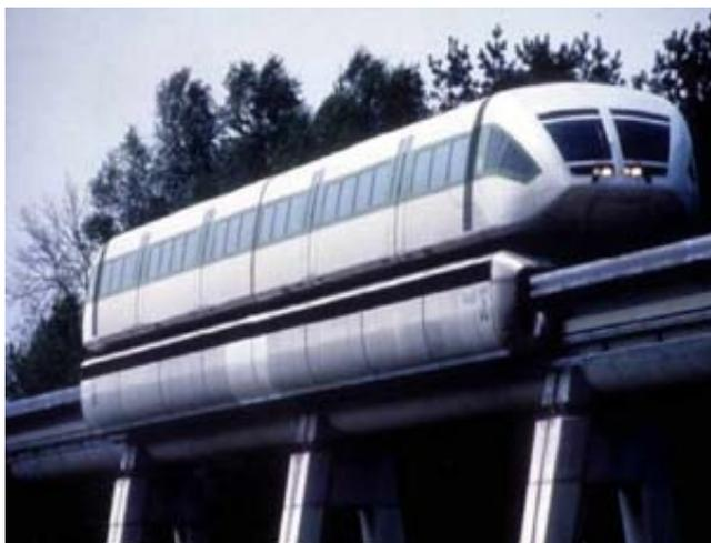
Figura 2.6 Tren de levitación magnética, que alcanza velocidades de 435 km/h, se está desarrollando en Alemania.
