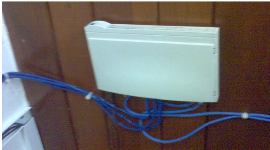
Figura 3. Nodos de red en el área de préstamo, conectados a un Hub 3Com.
