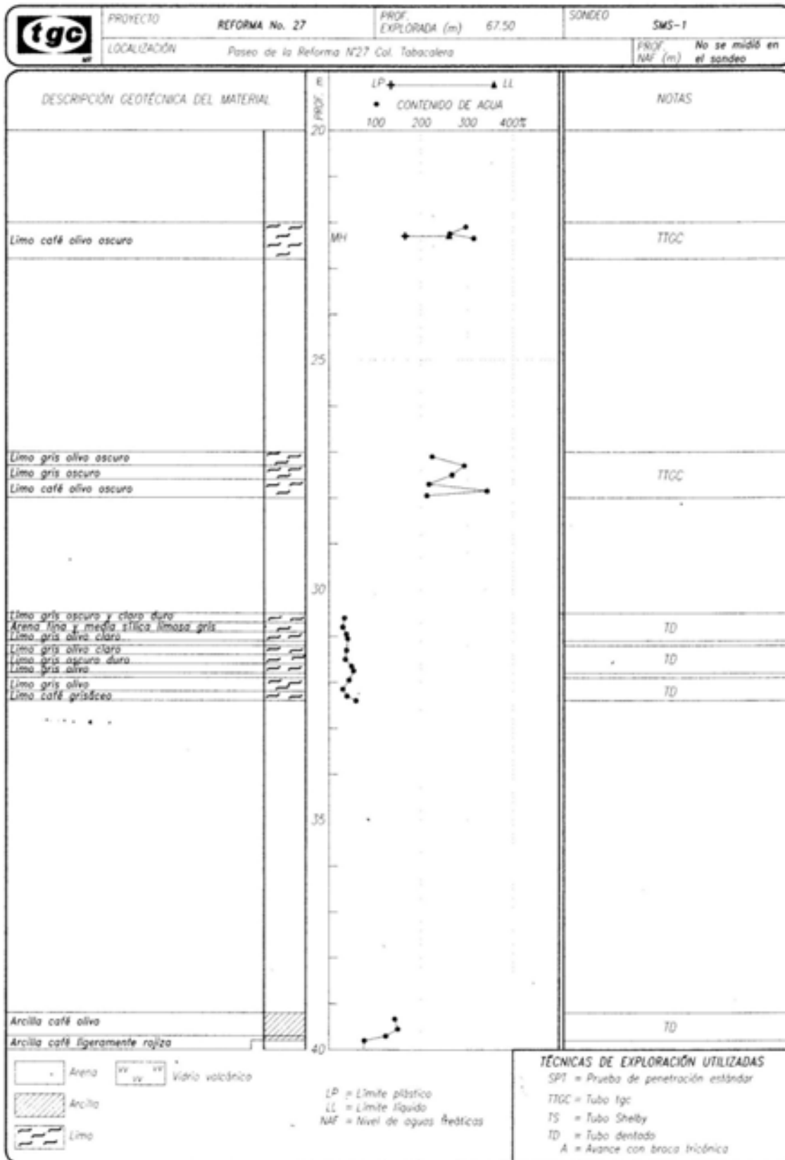
Fig. 2-5b Registro de exploración geotécnica (SMS).
