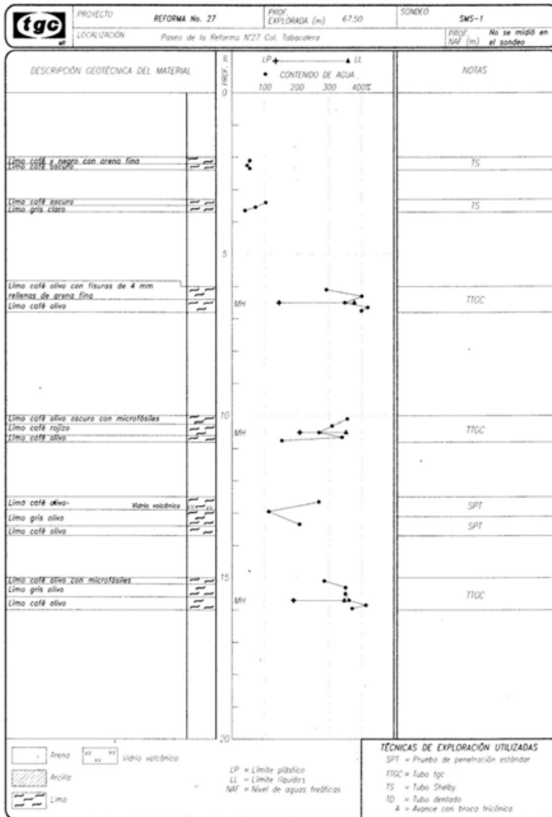
Fig. 2-5 a Registro de exploración geotécnica (SMS).
