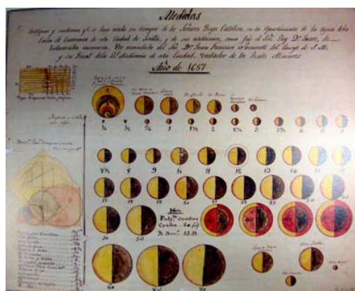
(42) Unidades de medida hidráulica de la ciudad de Sevilla, usadas desde la época de los reyes católicos.
