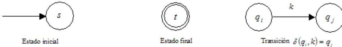
Figura 2.7: Representación Gráfica de un Autómeta a través de un Grafo Dirigido
