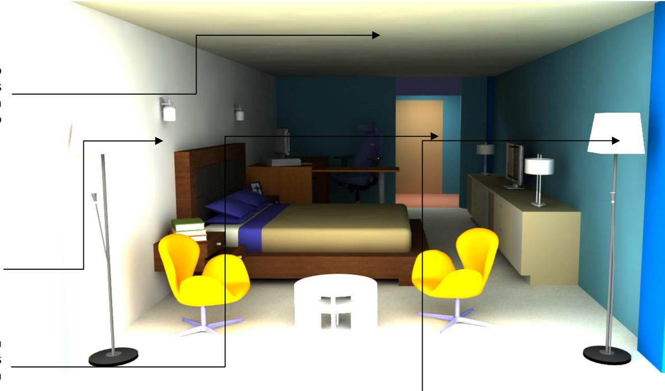
No se permitirá la instalación de ningún tipo de luminaria incandescente a menos que la eficacia comprobada de la misma sea de 50 lm/W, y la alimentación de dicha luminaria será exclusivamente de la red de generación solar local.
