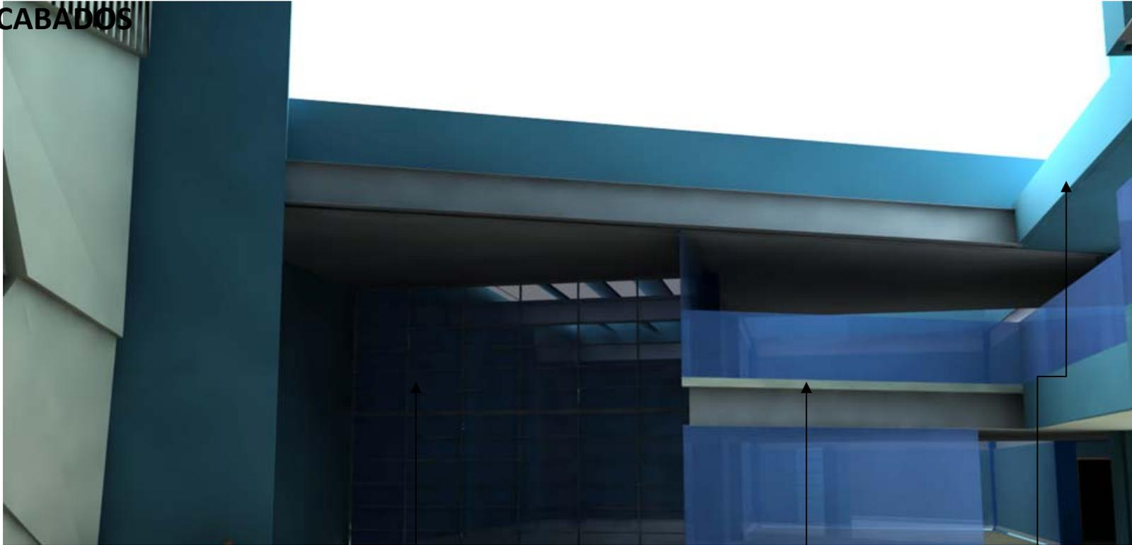
Canceles en Salón de Usos Múltiples de aluminio con acabado de transferencia de pintura color según diseño y vidrio laminado DIAMANT de Saint Gobain
