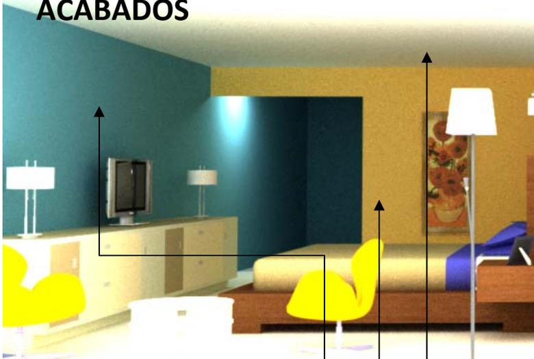
Acabado en muro en pasta texturizada Comex Texturi o equivalente, color y rodillo según diseño.
