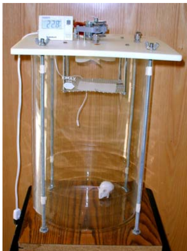
Imagen 1 Cámara estática utilizada para la exposición a disolventes de abuso
