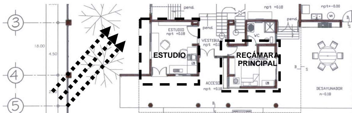
Imagen 7.- “Estudio y recámara principal”: El recuadro punteado indica los espacios generados para el estudio y la recámara principal, las flechas la dirección de los vientos dominantes.
