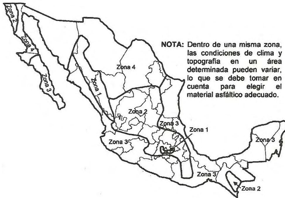
Figura 2.9 Regiones geográficas para la utilización de asfaltos clasificados según su viscosidad dinámica a 60°C
