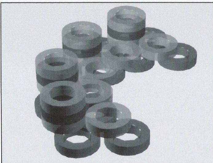
Figura 28 Esquema del acomodo de neumáticos para la construcción de las bancas.
