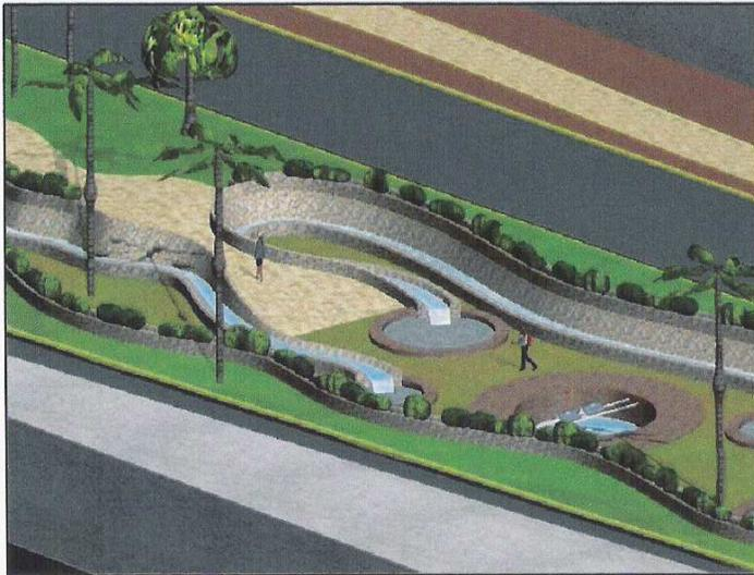
Figura 58 Vista del camellón ubicado entre las calles Altamirano y Juan Enríquez (sección F). Fuente de funcionamiento pluvial mediante la cual se muestra el proceso de captación, conducción, filtración y reutilización del agua.
