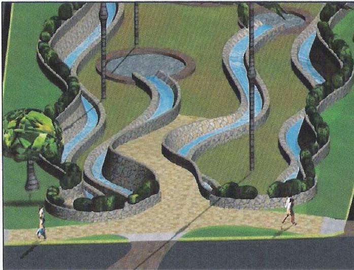
Figura 60 Canales a través de los cuales pasa por gravedad el agua de lluvia para ser filtrada durante su recorrido. Los canales conducen hacia filtros que limpian el agua de toda clase de basura y la direccionan hacia la cisterna de almacenamiento.
