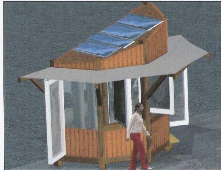
Figura 45 Mobiliario urbano kiosco de periódicos con funcionamiento a través de paneles fotovoltaicos.
