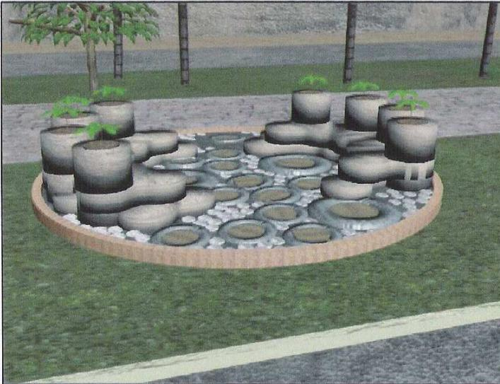
Figura 52 El módulo del mobiliario bancas se construyó con neumáticos reciclados, latas de aluminio, tierra compactada y con un revestimiento de estuco-cemento.
