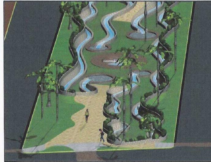
Figura 59 El agua es captada mediante canales de prefiltrado ubicados a ambos lados del perímetro del camellón, los canales tienen rejillas que evitan la introducción de basura de tamaño mediano.
