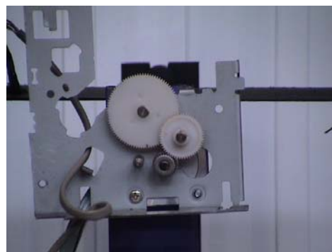
Figura 2.5 Tren de engranes relación 1: 8
