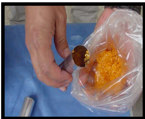
fig 19. Se llena el tubo de inyección
