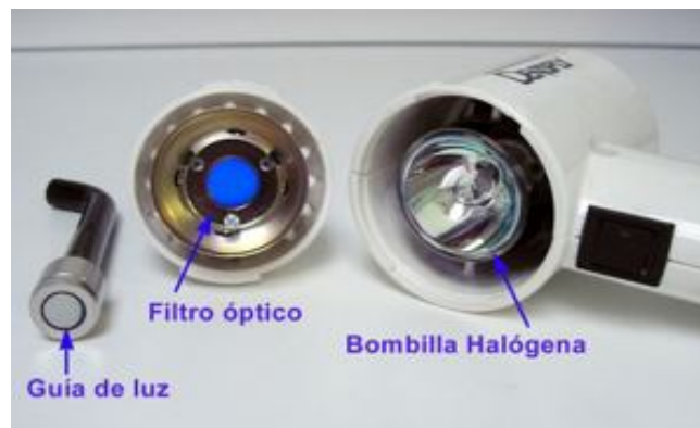
Bombilla halógena y filtro óptico para luz azul.
