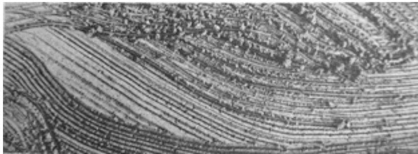
Figura 29 Textura dejada por la herramienta.
