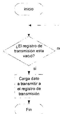
Figura 3.15 Diagrama de flujo de la rutina de transmisión por poleo "TRANSMITE".
