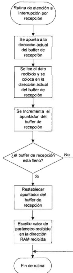
Figura 3.24 Diagrama de flujo de la operación de la rutina de atención a la interrupción por recepción de un dato en el módulo receptor del USART.
