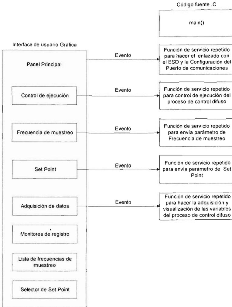
Figura 6.71 Diagrama de bloques de los principales componentes de la Interface de Monitorización y Configuración.
