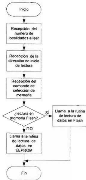
Figura 4.20 Diagrama de flujo de la operación de lectura del Modo Programación.
