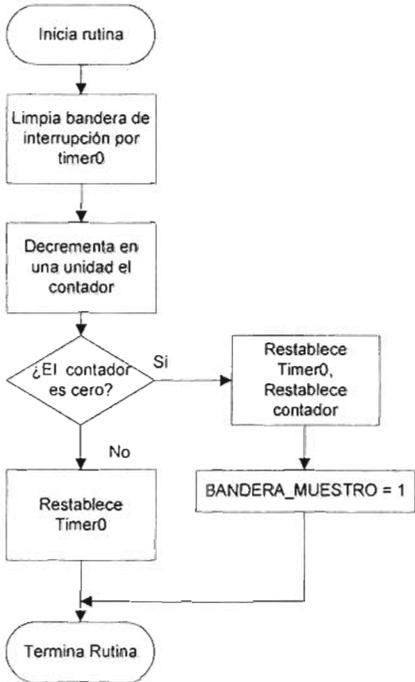
Figura 3.69 Diagrama de flujo de la rutina de atención a la interrupción por desborde del timer 0 (EJECUTAR\_PROCESO\_DIFUSO)
