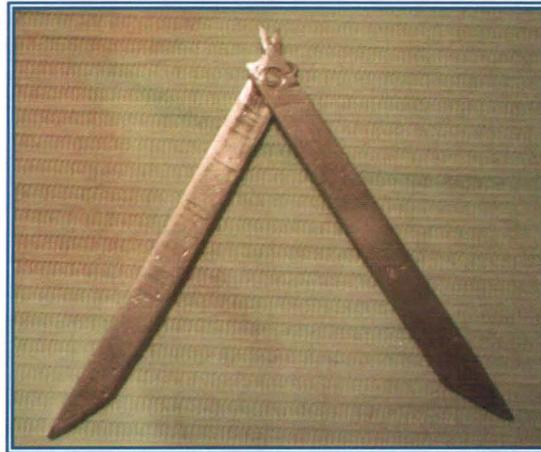
Figura 8. Muestra del compás utilizado para las mediciones de cada cúspide.
