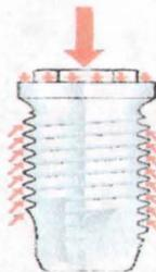
**Fig. 5-1** Si una fuerza se aplica a lo largo del eje axial de un implante (fuerza axial), la tensión se distribuirá alrededor de la sección transversal del implante y las roscas del implante.
