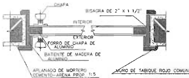
DETALLE 4 ARMADO DE PUERTAS
