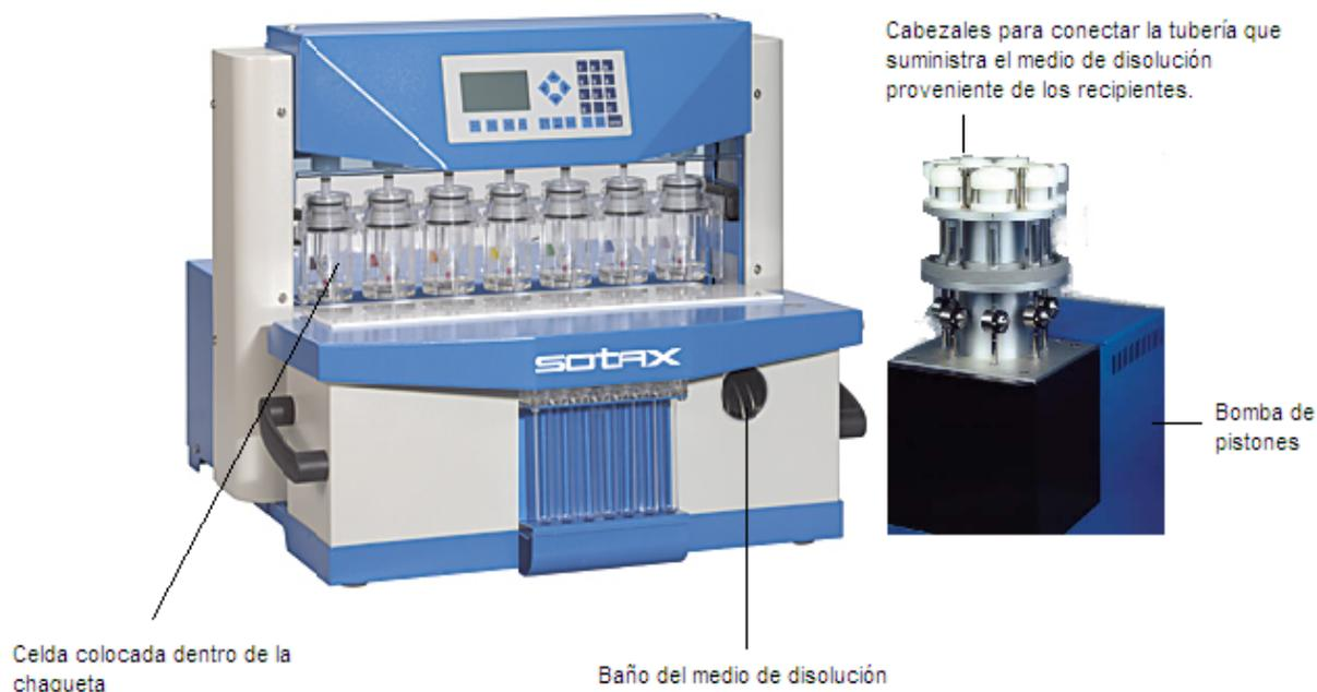
**Figura No. 10:** Ubicación del armado del equipo de disolución del aparato IV de la USP. (46)
