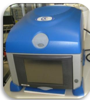
Figura 3.2. Termociclador Mod. ATC 401. Apollo instrumentation
