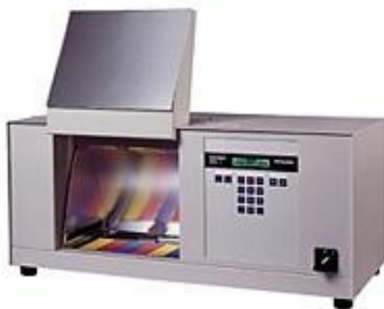
Figura 3.2 Simulador solar utilizado en las pruebas en laboratorio de Fenton y solar Fenton
