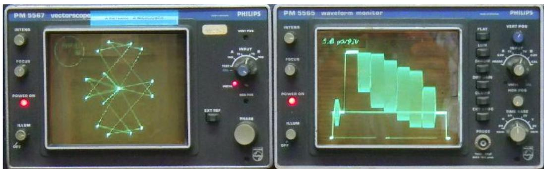
3.25 Vectorscopio y Monitor forma de onda.
