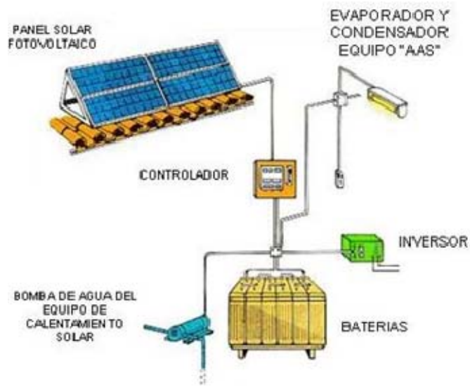
Figura 4.11 Diagrama de la instalación del sistema fotovoltaico
