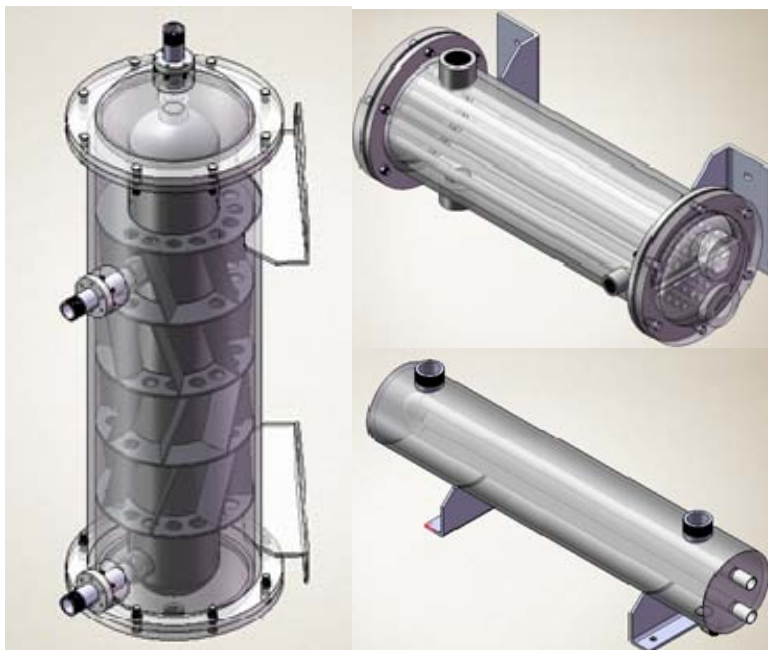
Figura 4.3 Vista de los intercambiadores de calor realizados con acero inoxidable.
