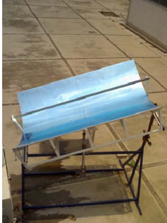
Figura 4.16 Estructura construida en centro tecnológico Aragón acoplada al concentrador solar
