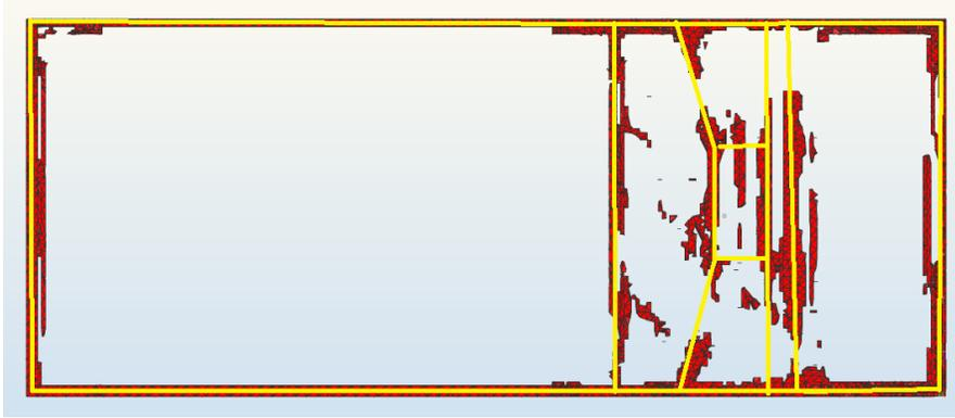
Figura 4.6 Rediseño de la sección superior sobre la malla resultante de la optimización topológica. Vista superior, corte sección superior.
