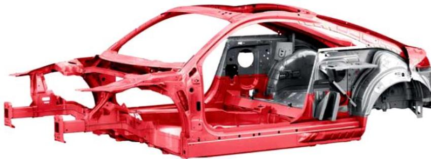
Figura 1.4 Audi TT, chasis monocasco. [Audi, 2010]
