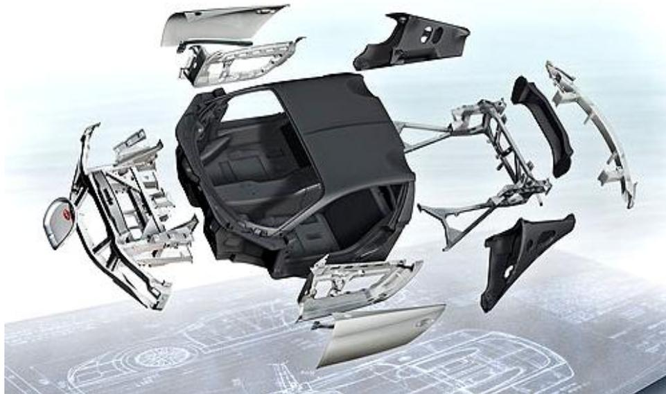
Figura 1.5 Bugatti Veyron 16.4 compuesto por dos chasis (delantero y trasero) además de un centro monocasco.
