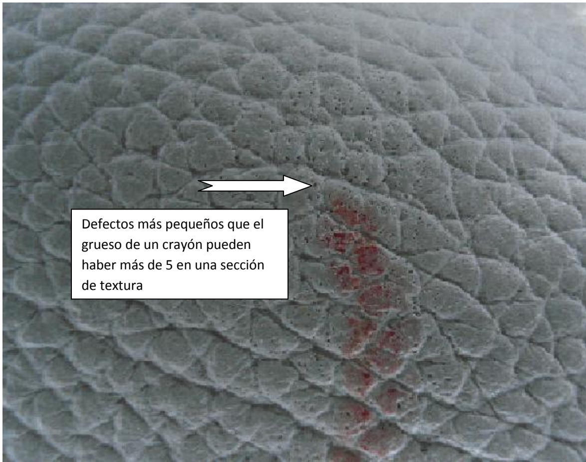
Figura 6: Imagen de una piel con defectos de 1 mm.
