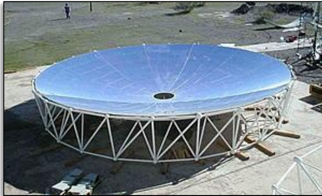
Figura 3.14: Concentrador solar Disco Parabólico.
