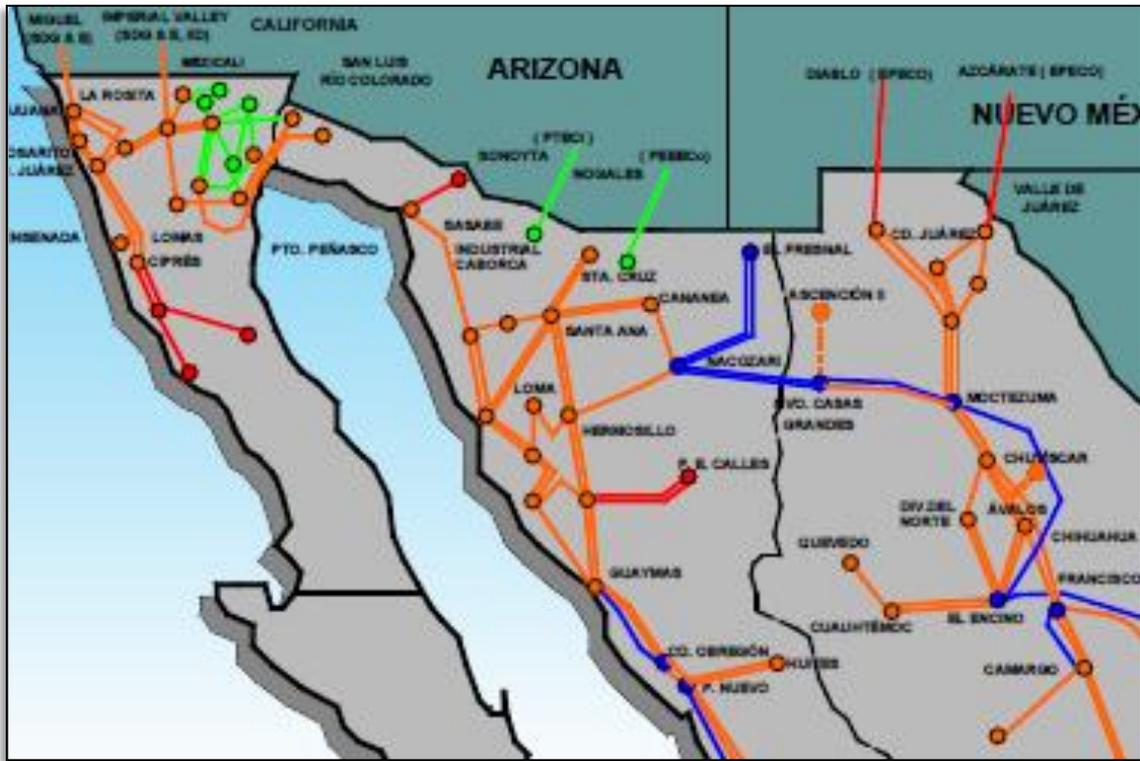
Figura 4.2: Red transmisión de 230 kV (línea naranja) para la salida de la energía eléctrica en Hermosillo, Sonora.
