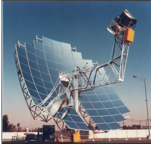
Figura 3.12: Concentrador solar de Disco-Stirling.
