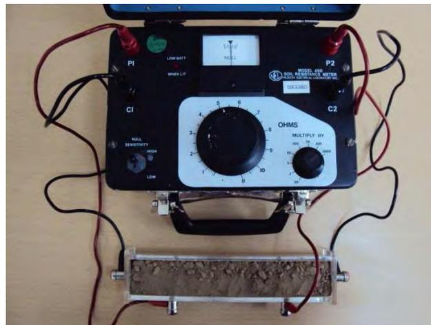
**Figura 2.9. Medición de la resistividad de una muestra**
