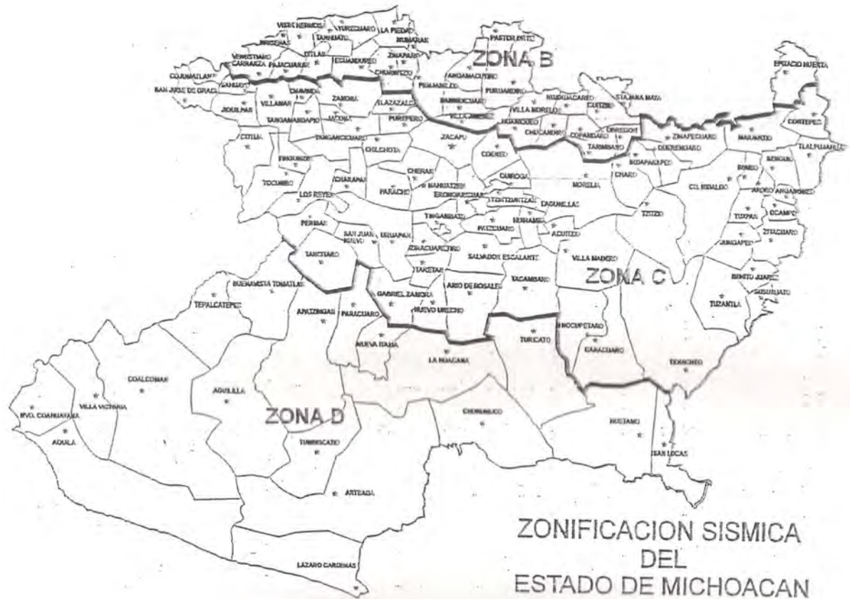
Imagen 3.4. Zonificación sísmica del Estado de Michoacán. Fuente: Diseño de Obras Civiles, Diseño por Sismo. C.F.E.
