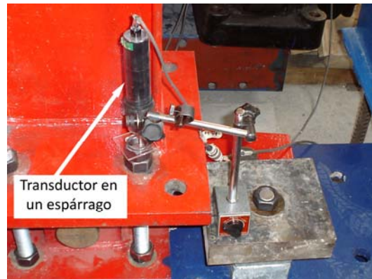
Figura 4.6 d.- Transductor para medir el desplazamiento de un espárrago.
