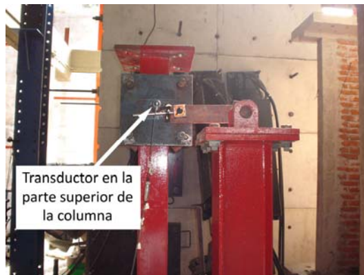
Figura 4.6 c.- Transductor para medir el desplazamiento en la parte superior de la columna.
