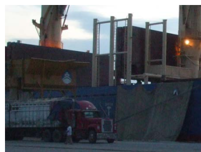
Foto 7.42 Lona atada al barco y el granel derramado caiga en muelle
