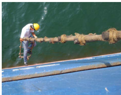
Foto 7.47 Toma de lectura de calados para el Draft Survey final.
