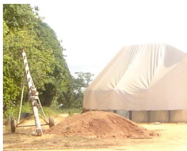
Foto 7.41 Gusano sinfin que traslada el granel del camión a una bodega de destino
