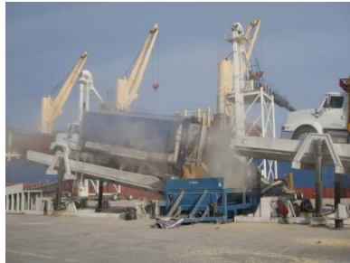
7.12 Abertura completa de las puertas traseras del camión
