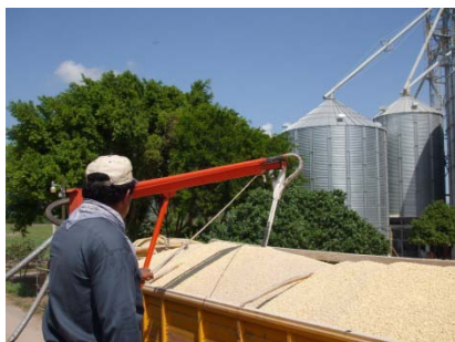
Foto 7.21 Toma de muestra del camión que esta en bascula
