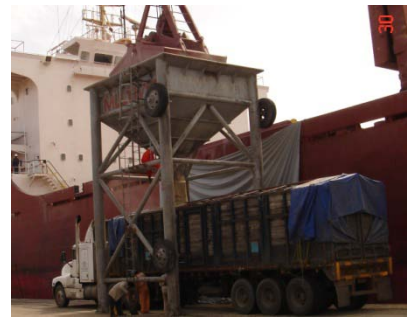
Foto 7.33 posicionamiento del camión debajo de la tolva
