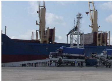
Foto 7.10 Rampa donde sube el camión para ser descargado
