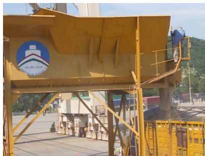
Foto 7.36 Tolvero dando la indicación de avance al camión para su llenado completo
