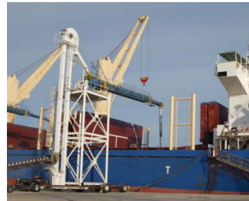
Foto 7.15 elevador de canjilones y desembocadura hacia la escotilla
