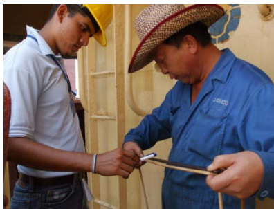
Foto 7.31 Lectura de calados en buque y determinar del Draft. Survey inicial
