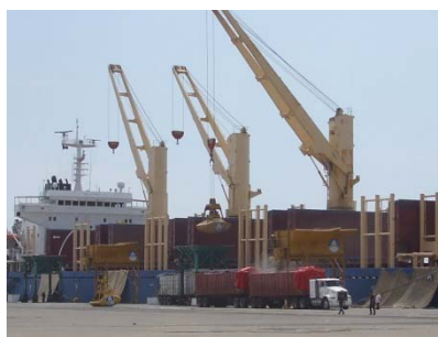
Foto 7.32 Descarga del granel por medio de almejas y grúas a camiones.
