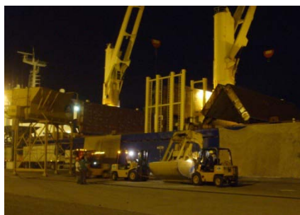
Foto 7.48 Cierre de compuertas de una escotilla ya vacía de granel
