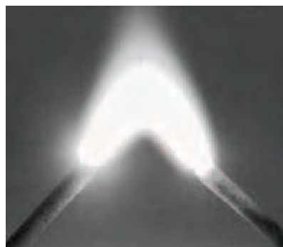
Figura 1.4 Arco eléctrico formado por electrodos de grafito.
