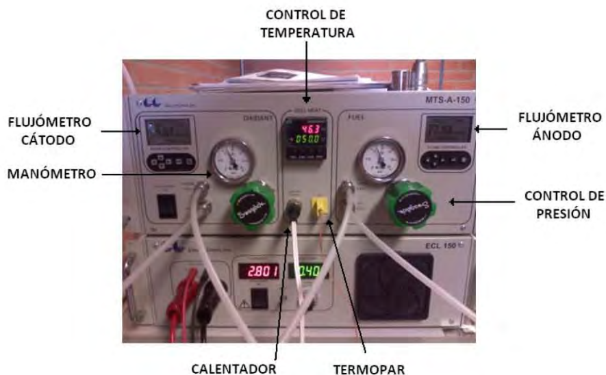
Figura 4.11. Componentes principales de la estación de pruebas.
