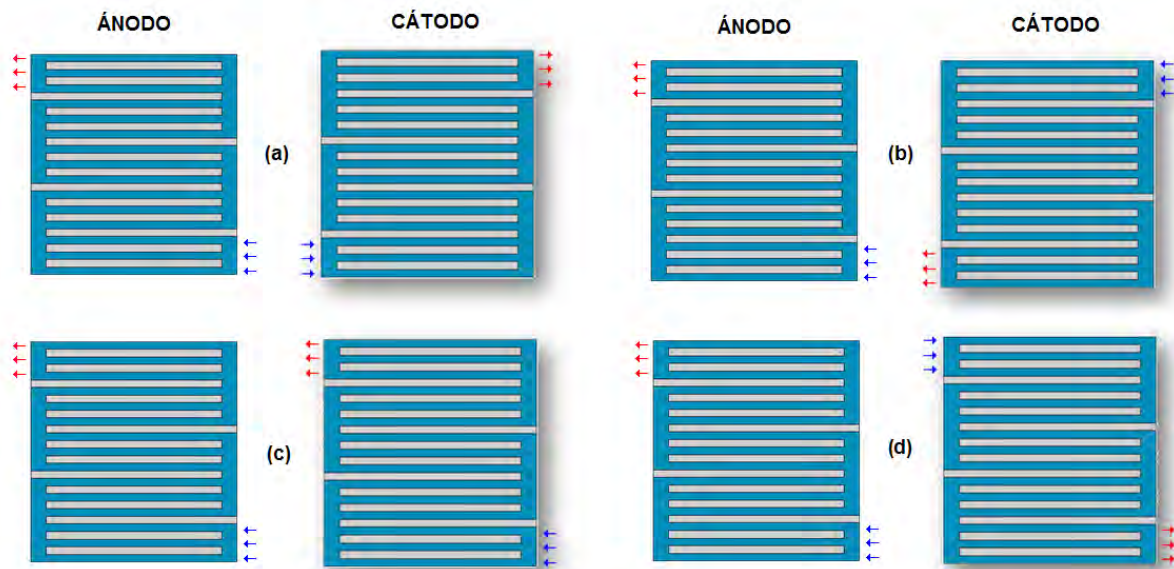
Figura 2.7. Diferentes formas de alimentación de gases para la celda comercial, a) flujos cruzados, b) flujos asimétricos, c) flujos iguales y d) flujos opuestos.
