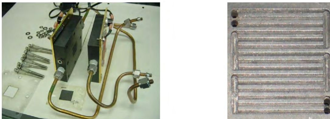
Figura 2.5. Celda de combustible comercial con canales en serpentin.
