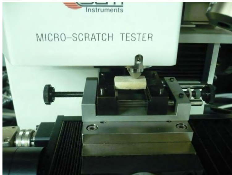
Figura XL.- Muestra en proceso de rayado
