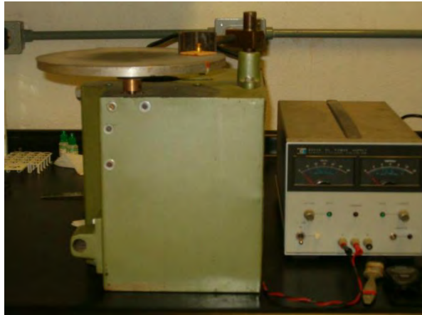
Figura XXIII.- Equipo de Abrasión
