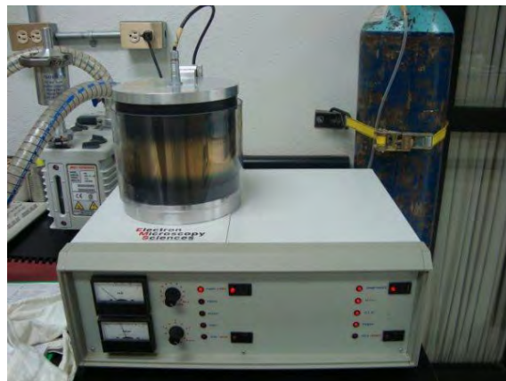
Figura XXVI.- Evaporadora de metal Sputter Coater EMS 550
