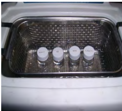
Figura XVIII.- Muestras en baño ultrasónico
