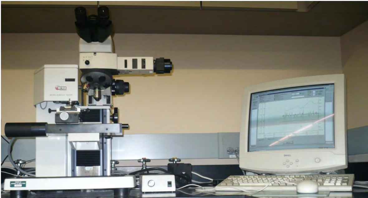
Figura XXXIX.- Micro-Scratch Tester (MST)
