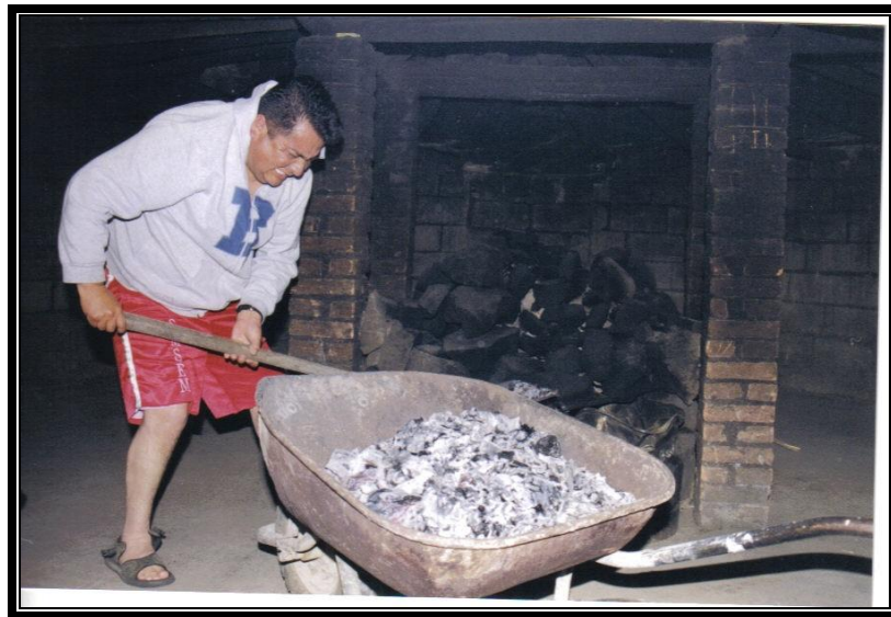
Figura 18. Extracción de ceniza, para la limpieza de la hornilla.
