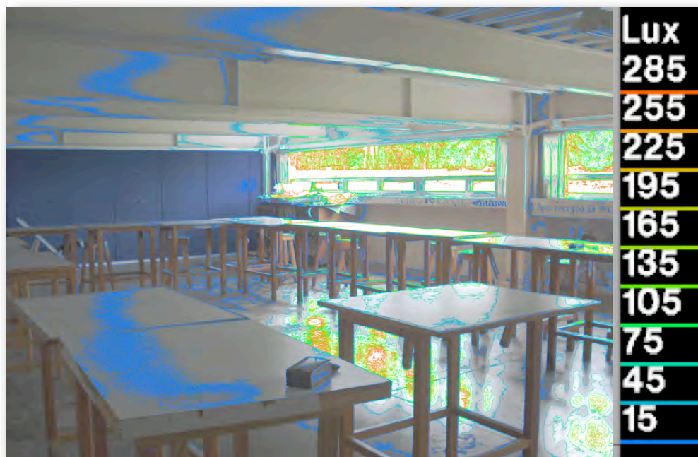
< FIGURA 98 Caso de estudio 3 Taller de arquitectura en Imagen HDR con curvas de iluminancia y sus valores correspondientes.
