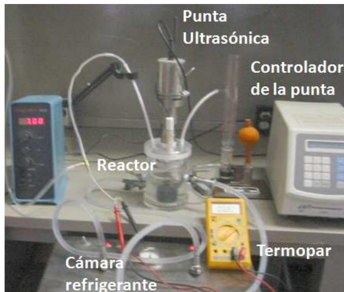
**Figura 3.4:** Vista general del dispositivo experimental para realizar procesos de sonólisis para sintetizar matrices vítreas de  $\text{SiO}_2$  vía la ruta sonogel.
