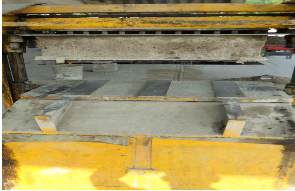
FIGURA 25 Máquina madre para hacer block, celosía y adoquín.
