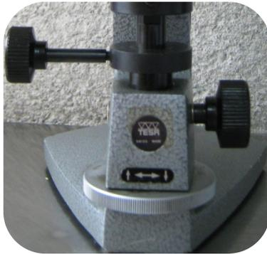
Figura 22. Perilla y disco de ajuste de altura.
