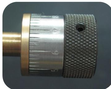
Se comprobó la graduación del tornillo micrométrico con el uso del calibrador vernier digital (Mitutoyo, Japón).
