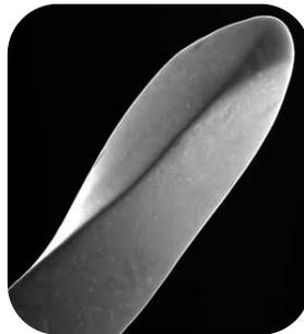
Figura 17. Punta de Precisión EndoSequence.
