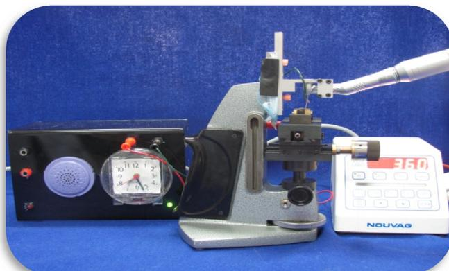
Figura 27. Aparato para pruebas de fatiga cíclica en funcionamiento.
