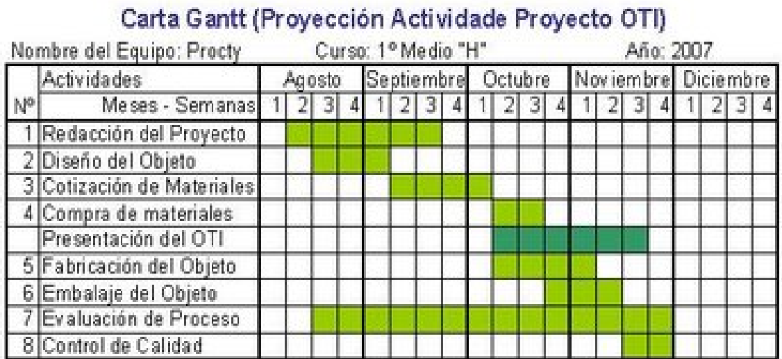
FIGURA 2.4. Ejemplo de cronograma de actividades mediante la utilización de un gráfico de Gantt.
