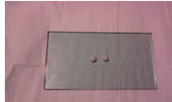
Fig. No. 4 Especímenes de resina Signum de 1.5 y 2.0 mm de grosor
