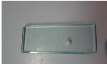
Fig. No. 3 Espécimen de Resina Signum de 1.5mm de grosor.
